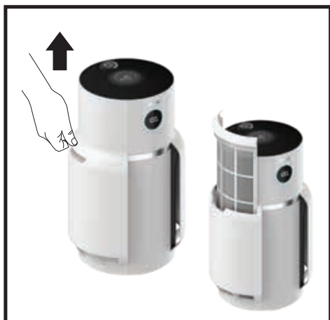
1. LOCALISER ET RETIRER LES FILTRES À POUSSIÈRE EN MAILLE
