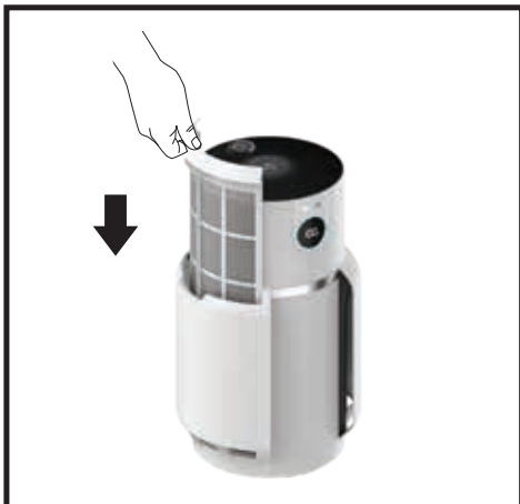
4. WIEDEREINSETZEN DER MESH-STAUFILTER
